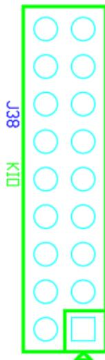
如下图所示：6 和 8 脚外接轻触开关，短按开关屏、长按开关机（需软件支持）；5 和 7 脚外接轻触开关可以实现按键复位；2 和 4 脚可以接 LED 灯实现工作指示（LED 信号电压经过了内部分压，如果无法点亮则可用 1 和 3 脚直接做电源指示）。K1 音量+、K2 音量-、K3 休眠/唤醒、K4-返回、K5-HOME（需软件支持），K6~K8 自定义。
